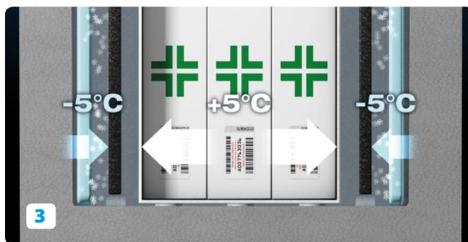
1. La **parte interna** della scatola è **alluminata** in modo da "trattenere" la temperatura del farmaco il più stabile possibile.
